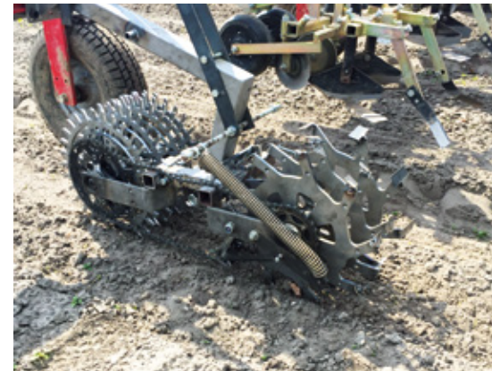
Mit verschiedenen Prototypen wurde die unkräutregulierende Wirkung der elektrischen Hacke getestet.
