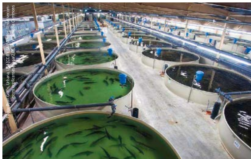
Indoor-Kreislaufanlage im Produktionsbetrieb – In solchen Anlagen kann nahezu jede Fischart gezüchtet werden. Wegen des technischen Aufwands lohnen sich in der Regel nur hochpreisige Fischarten (z. B. Steinbutt, Wolfsbarsch, Aal, Zander, Stör).
