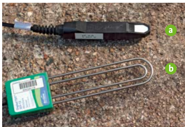
Abb. 6.6.1: Digitale Bodenfeuchtesensorik zur Bewässerungssteuerung (a) „Trockenes“ Tensiometer (Tensiomark) und (b) TDT-Sensor (Acclima), Foto: J. Gräfe, IGZ Großbeeren.
