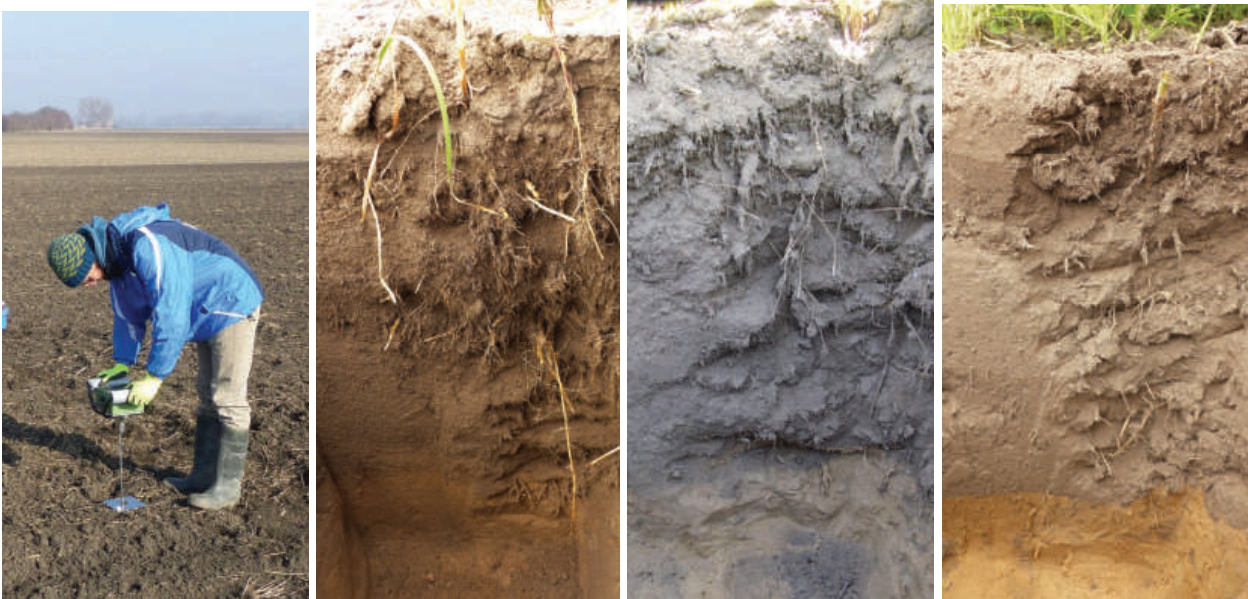
Messung des Eindringwiderstands mit einem Penetrologger (Bodensonde) vor der Lupinensaat und drei Böden mit dichtlagerndem Sand im Unterboden
