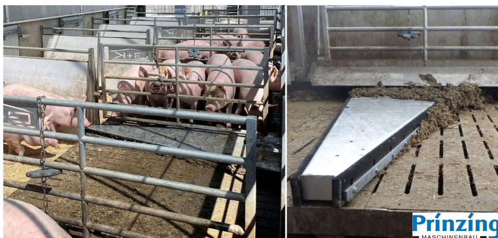
Abbildung 34: Schweineauslauf mit Oberflurschieber.
