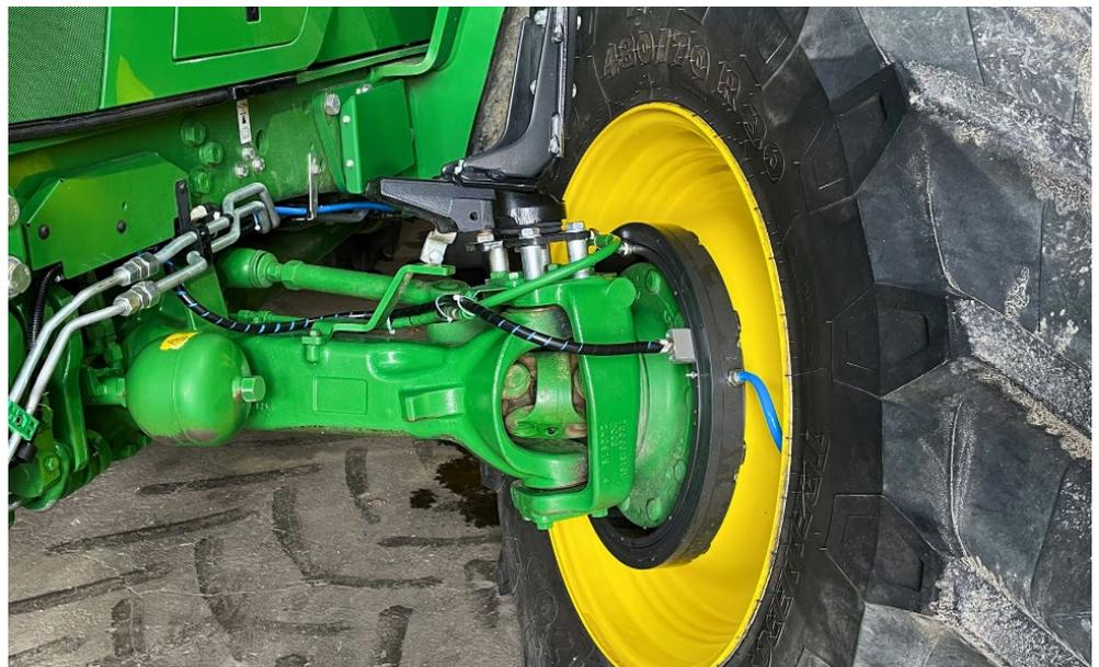
Abbildung 1: „VariQtire“ Systemaufbau Vorderachse.
