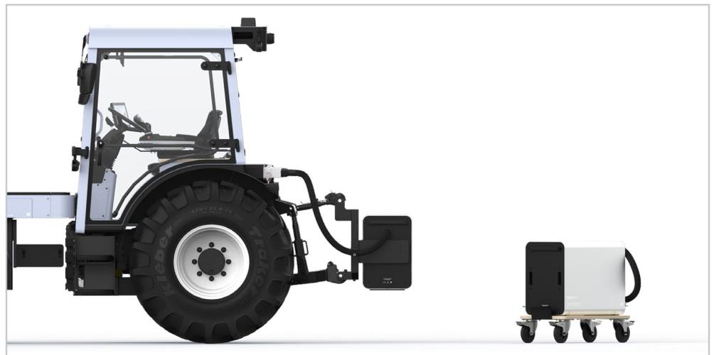
Abbildung 3: Der ONOX Traktor mit einem angehängten Batteriewechselmodul und einem Batteriewechselmodul auf einem mobilen Träger.
