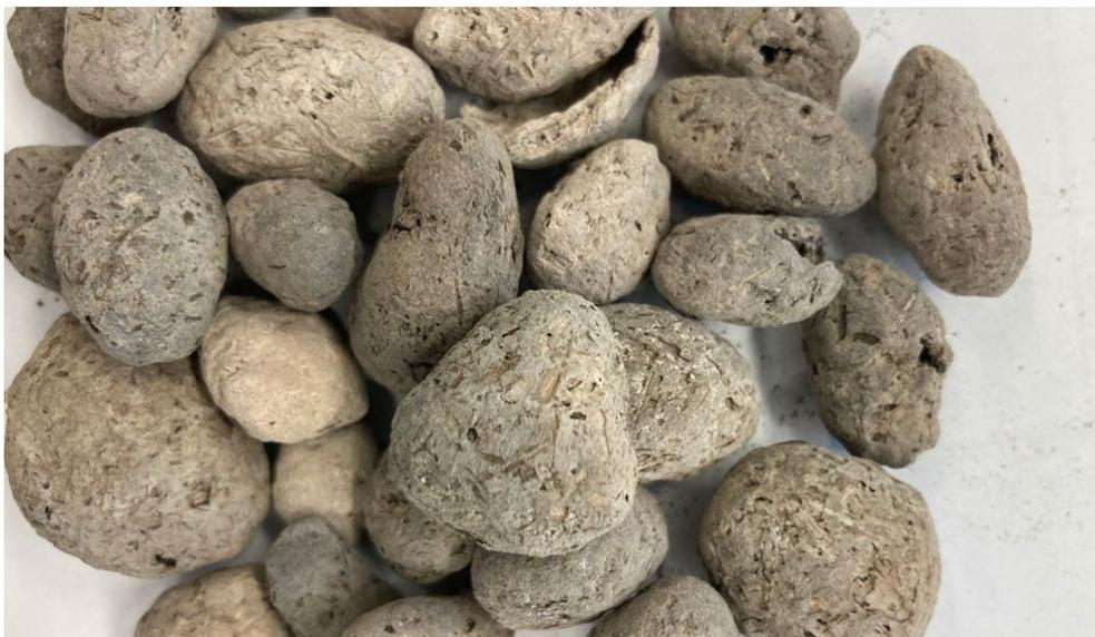
Abbildung 66: Funktionalisierte Granulate auf Basis von Bau-Reststoffen.
