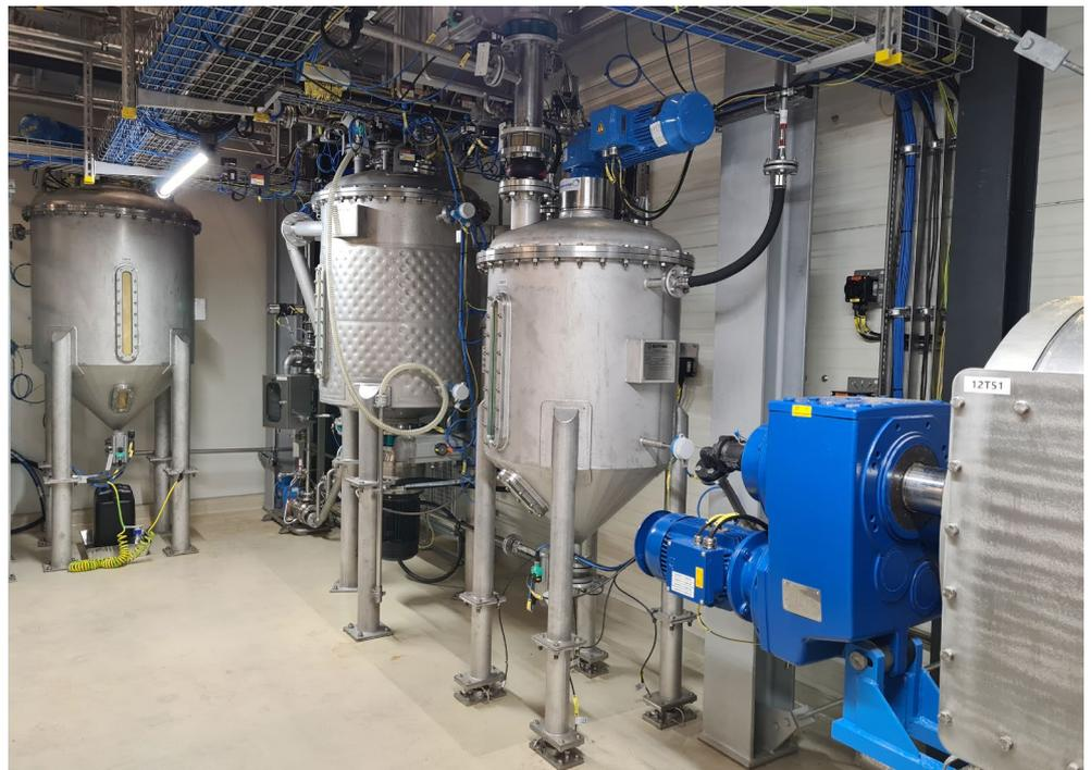
Abbildung 49: Ausschnitt der EthaNä-Anlage®, in der neue Verfahren für die Verarbeitung von Rapssaat im Pilotmaßstab entwickelt werden.
