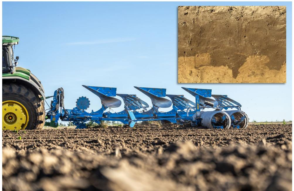
Abbildung 2: CF-Pflug mit Packer im Einsatz sowie damit erzielttes Bodenprofil (oben rechts).
