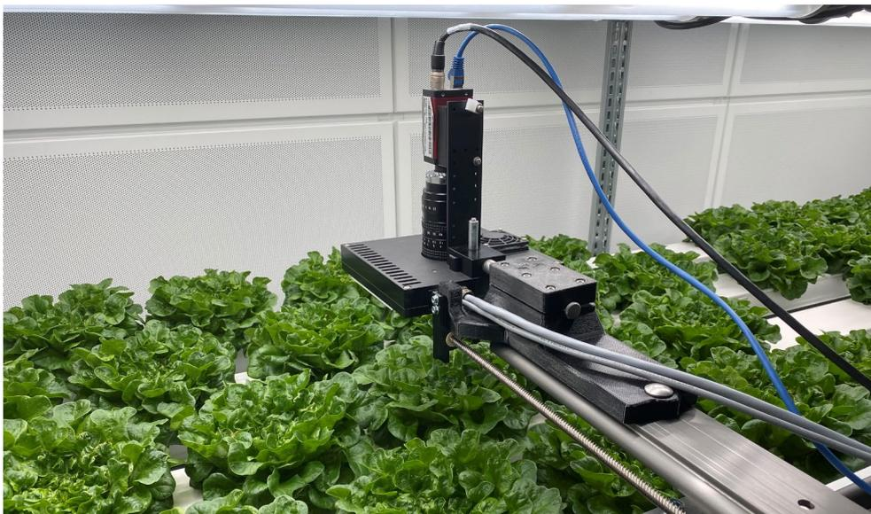
Abbildung 68: Automatisierter Messvorgang zur Bestimmung der Chlorophyll-Fluoreszenz von Salatpflanzen mittels Imaging-PAM (Walz) in einer Indoorfarm an der Hochschule Osnabrück.
