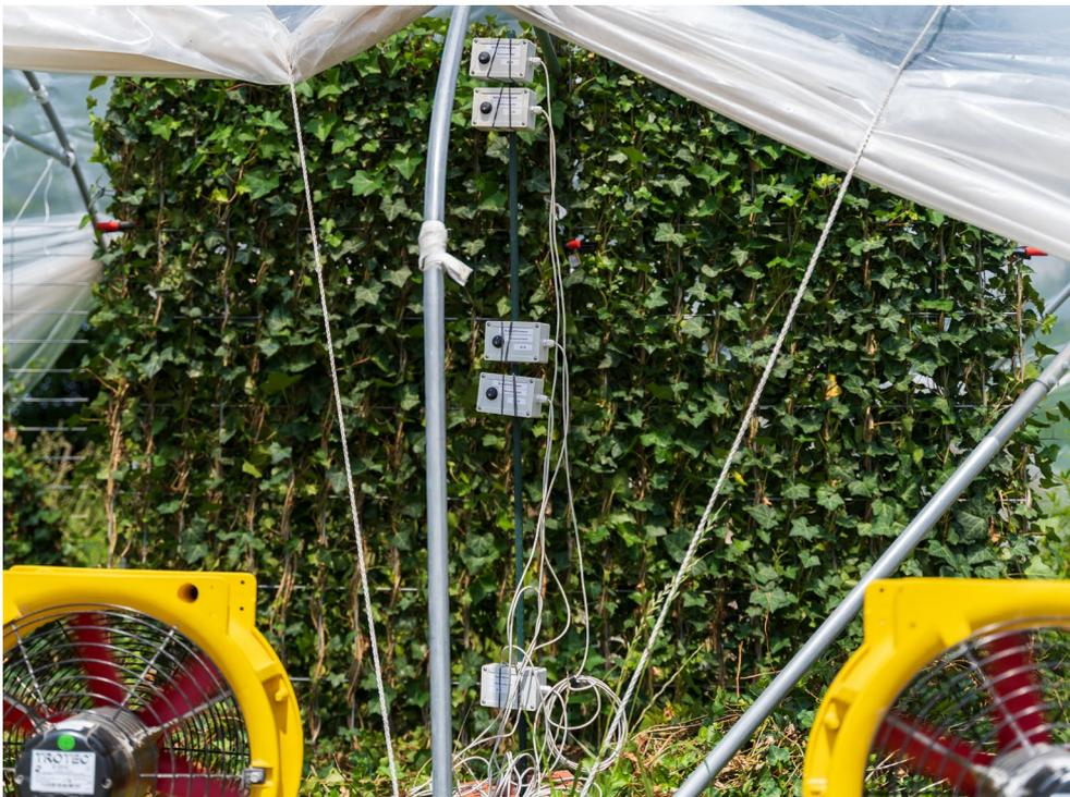
Abbildung 65: Die „SmartGreen“-Sensormodule vor der Efeuwand im Außenlaborversuch.
