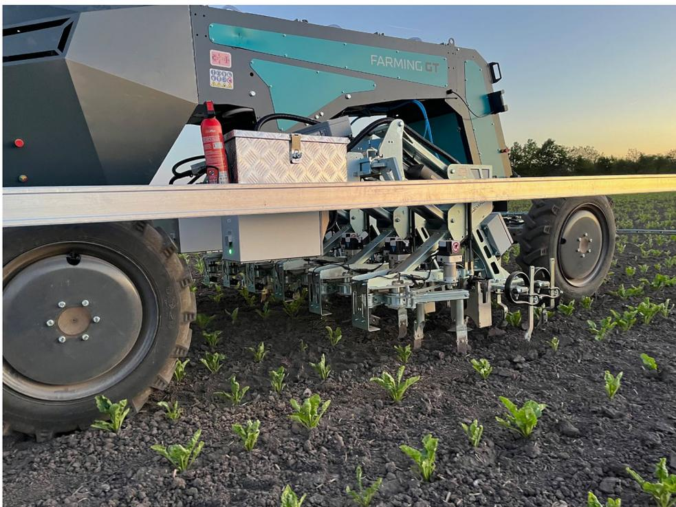
Abbildung 7: Das neue Hackaggregat, montiert an den Roboter.
