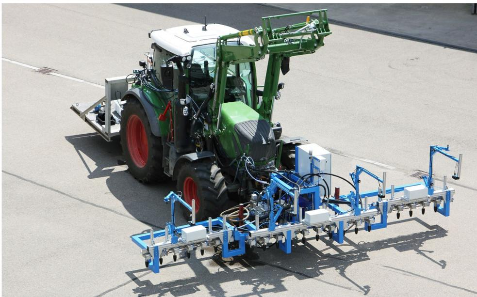
Abbildung 19: Traktor mit angebautem Wasserhochdruck-Unkrautbekämpfungsgerät und Versorgungsplattform.
