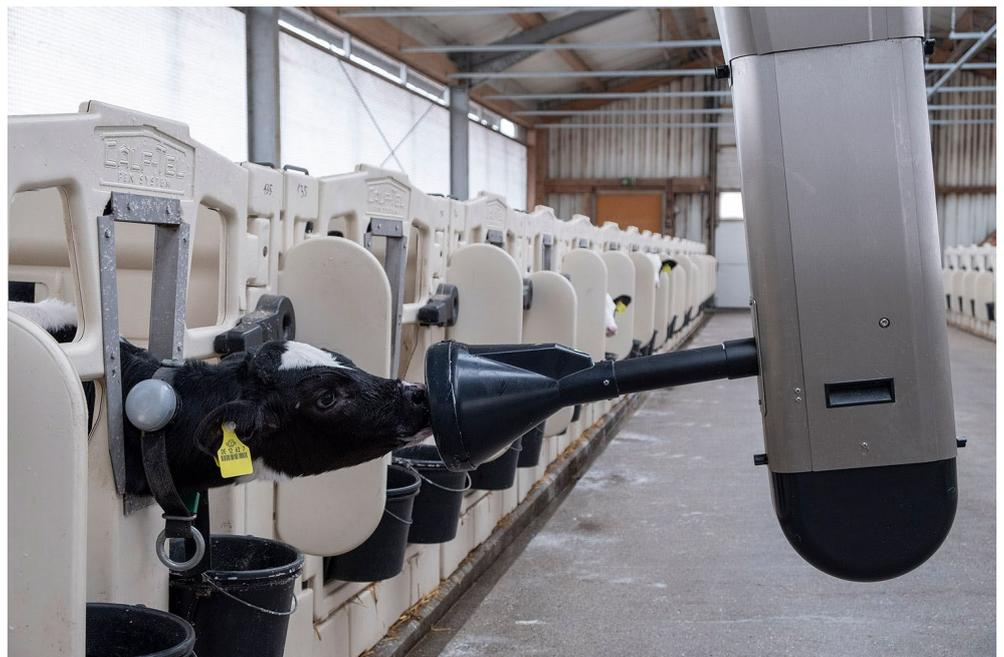
Abbildung 32: Kalb während der Milchaufnahme an der CalfRail-Tränkestation für die Einzelhaltung mit SmartNeckband-Aktivitätssensor am Halsband.
