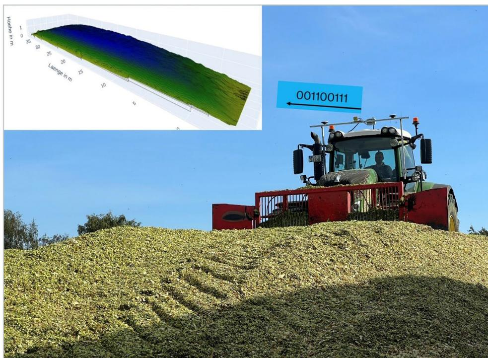
Abbildung 20: Silage Control im Einsatz mit einer Darstellung des erfassten Silos.
