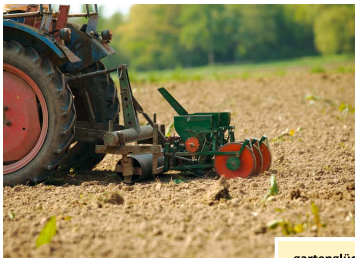
Einzelkornsämaschine hinter dem Traktor (Foto: © Volker Gehrmann)
