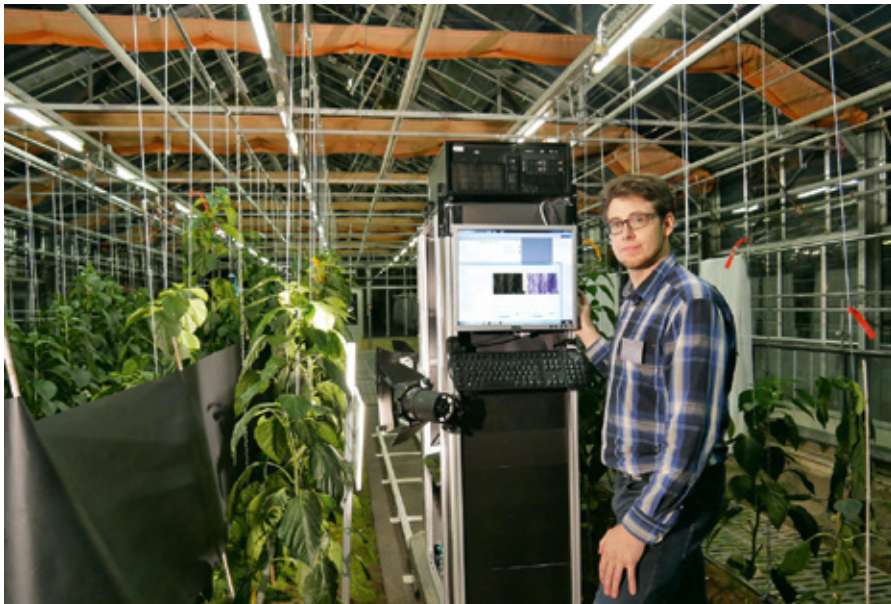
Mobiler Messstand zur Analyse des Gesundheitszustands von Paprikapflanzen
