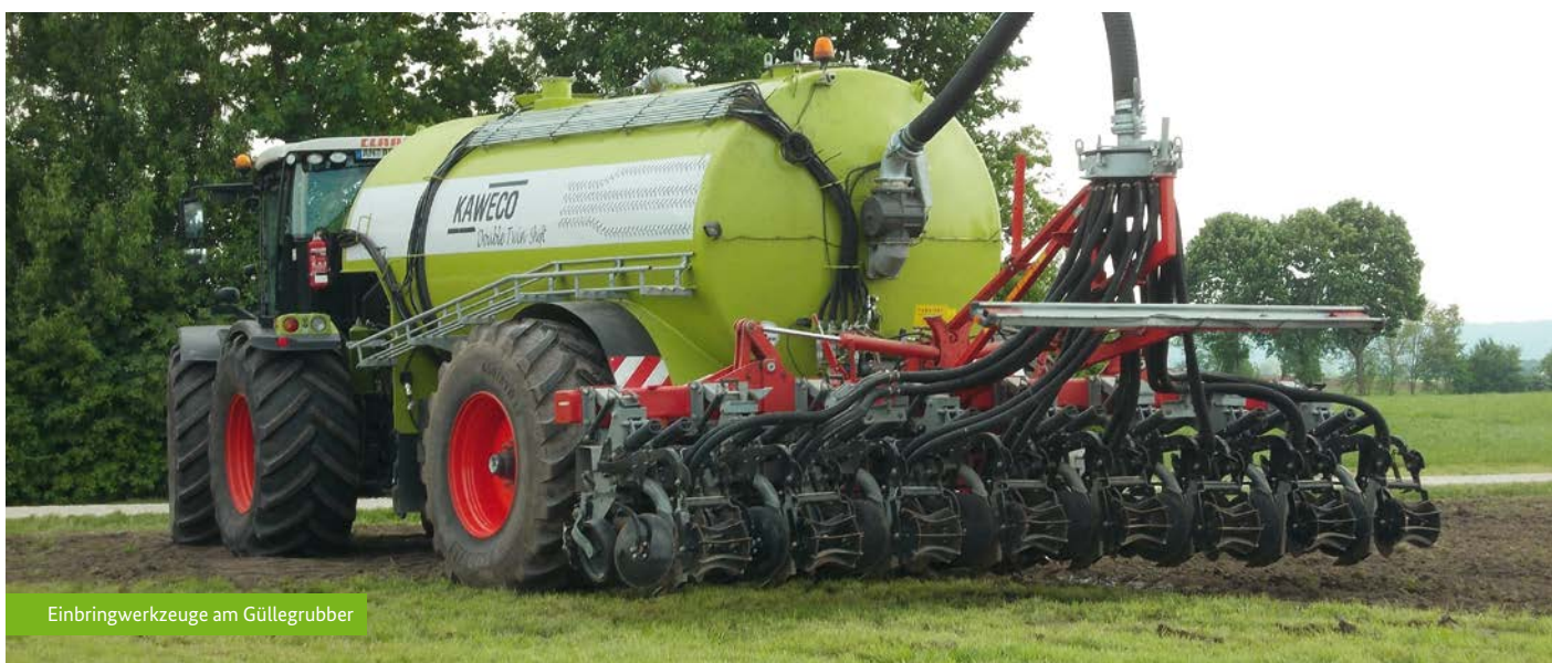
Güllegrubber zur unverzüglichen Einarbeitung im Einsatz
