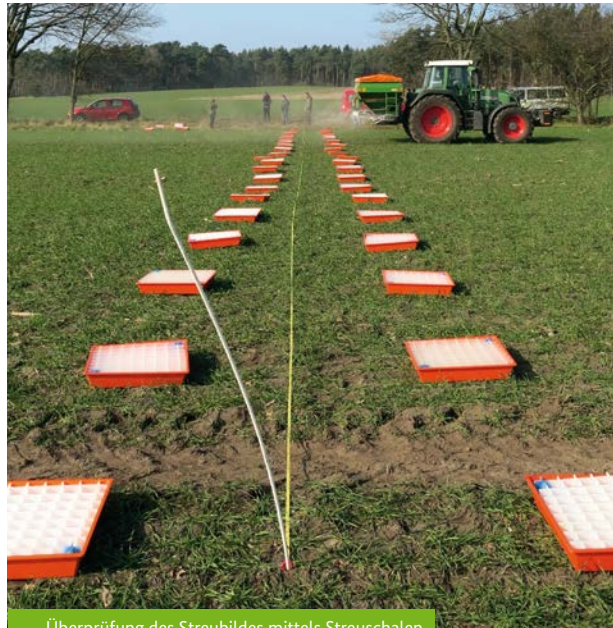
Überprüfung des Streubildes mittels Streuschalen
