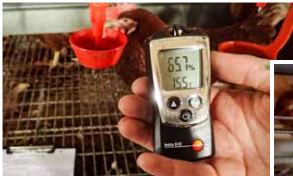
Thermo-Hygrometer zum Messen von Temperatur und Luftfeuchtigkeit
