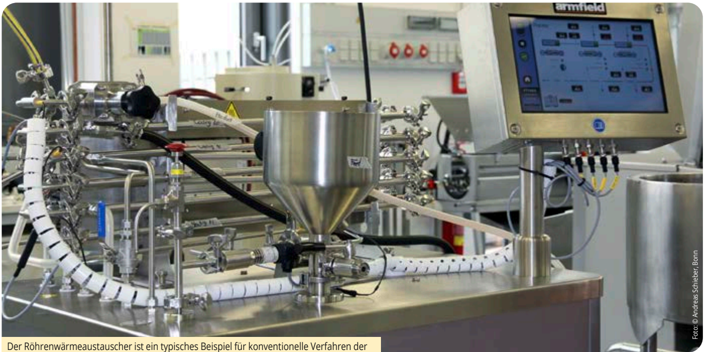
Der Röhrenwärmeaustauscher ist ein typisches Beispiel für konventionelle Verfahren der Lebensmittelverarbeitung. Er eignet sich für die Erhitzung flüssiger und pastöser Produkte.
