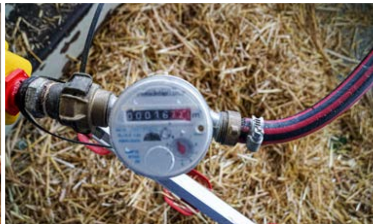
An der Tränkelinie ist eine Wasseruhr zur Kontrolle des täglichen Wasserverbrauchs eingebaut.
