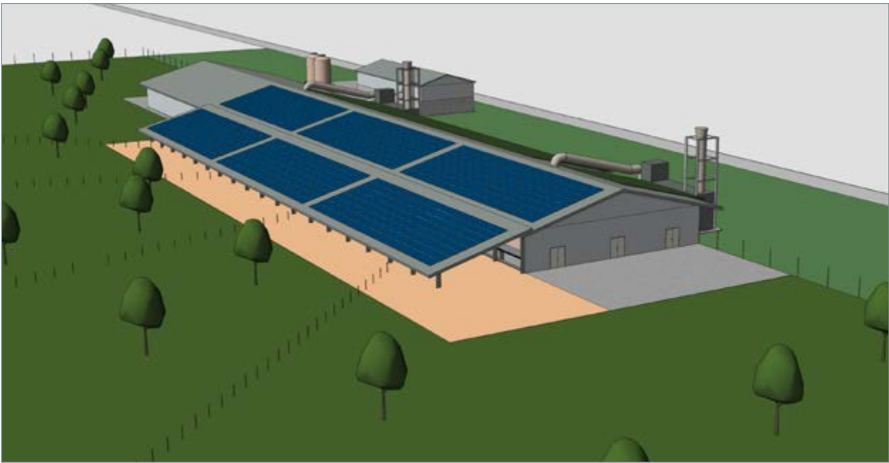
Abb. 70: Legehennenstall mit einseitigem Kaltscharrraum, überdachtem Auslauf und angrenzender Freifläche.
