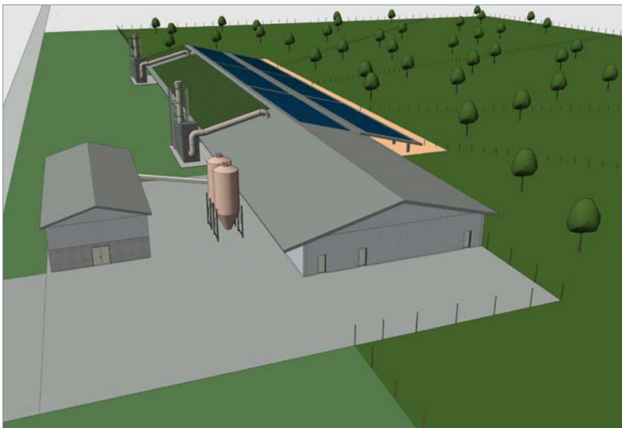
Abb. 75: Planungsbeispiel mit Luftwärmetauscher, PV-Anlage und Dachbegrünung. Bewachsener Freiauslauf.
