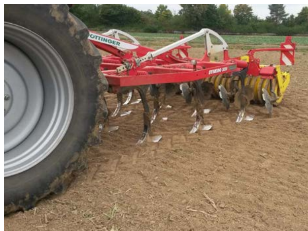
Abb. 4.4: Bei herkömmlichen Grubbern können für die flache Bearbeitung die Schare ausgetauscht oder wie hier mit Flügelcharen ergänzt werden. (Foto: N. Uppenkamp)
