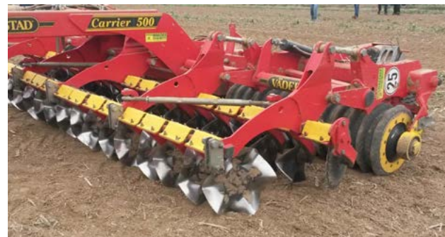
Abb. 4.8: Kurzscheibenegge mit stark gewellten Scheiben für die ultraflache Bodenbearbeitung (Foto: N. Uppenkamp)
