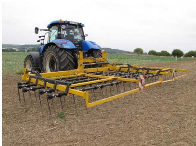
Abb.4.2: Strohstriegel mit Zinken in einem Strichabstand von 6 cm (Foto: N. Uppenkamp)
