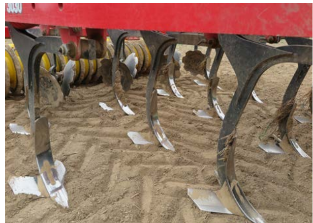
Abb. 5.12: Dreibalkiger Grubber mit Flügelscharen (Foto: M. Landschreiber)
