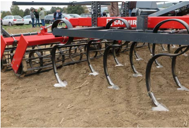
Abb. 5.13: Großfederzinkenegge mit Gänsefußscharen und Doppelkrümmer (Foto: M. Landschreiber)
