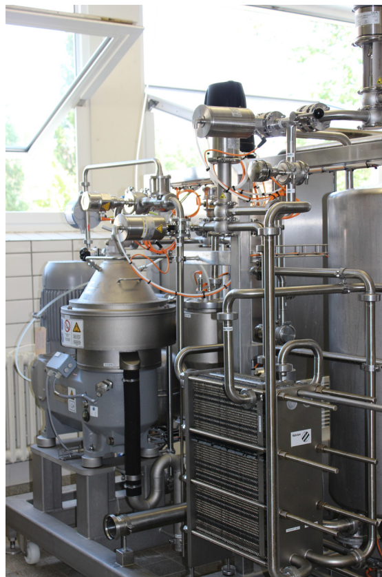
Abb. 2: „GEA Entkeimungsseparator CSC 18“ im Milchtechnikum der Hochschule Hannover (© Hochschule Hannover).
