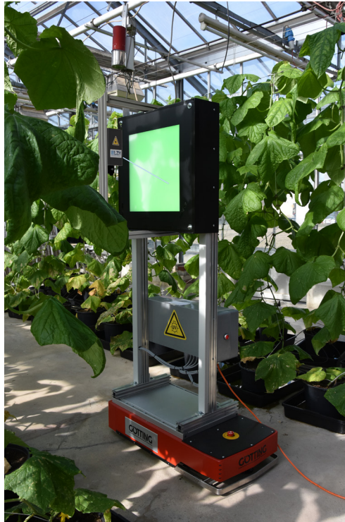
Abb. 3: LED- Laser-Kombifalle (Fotomontage) im Gewächshaus (© Institut für Gartenbauliche Produktionssysteme (IPGS) Hannover, Laserzentrum Hannover e.V.)
