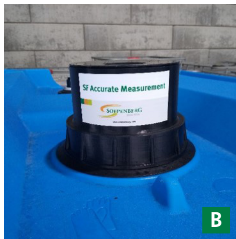
Abb. 2: (A) Externer Prozessbehälter zur Ansäuerung des Flüssigmistes (B) IBC-Aufsatz zur automatischen Füllstandsmessung und Datenübertragung. (© Overmeyer/Universität Bonn; SF-SoepenberG GmbH).
