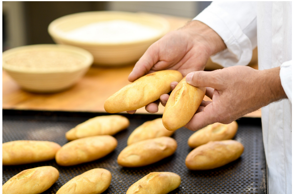
Abb. 1: Brötchen aus dem Rapid-Mix-Test zur Beurteilung der Backqualität. Hier im Bild sind die Ergebnisse aus Mehlen mit schwacher Qualität mit schmäler Form, geringem Volumen und wenig Ausbund zu sehen (© Tobias Hase/STMELF).
