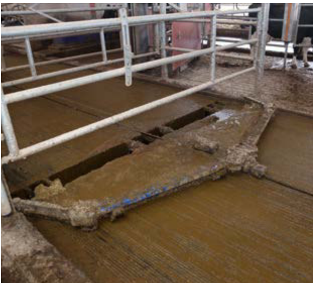
Faltschieber (oben)/Klappschieber (links) zum Abschieben der Gülle auf planbefestigten Laufflächen: Der entstehende Güllesee (rechts) stellt in Bezug auf Emissionen und Klauengesundheit ein Problem dar.
