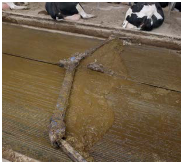
Faltschieber (oben)/Klappschieber (links) zum Abschieben der Gülle auf planbefestigten Laufflächen: Der entstehende Güllesee (rechts) stellt in Bezug auf Emissionen und Klauengesundheit ein Problem dar.
