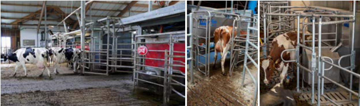
Kühe beim Eintritt in die und Austritt aus der Melkbox des AMS.
