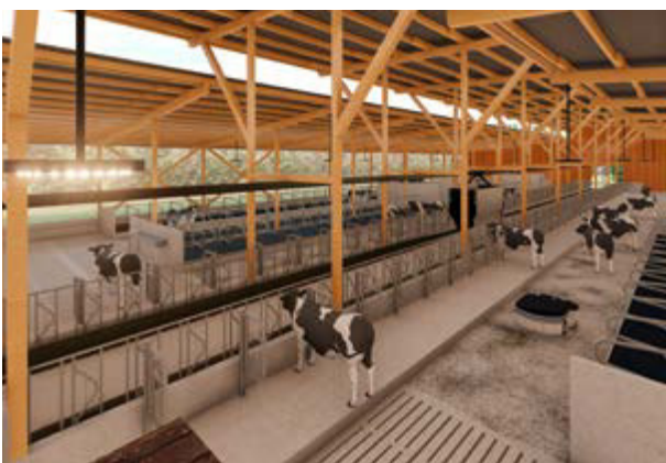
Strukturierung der Stallbereiche im Umweltstall durch Fressstände (links) und Liegeboxen (rechts).
