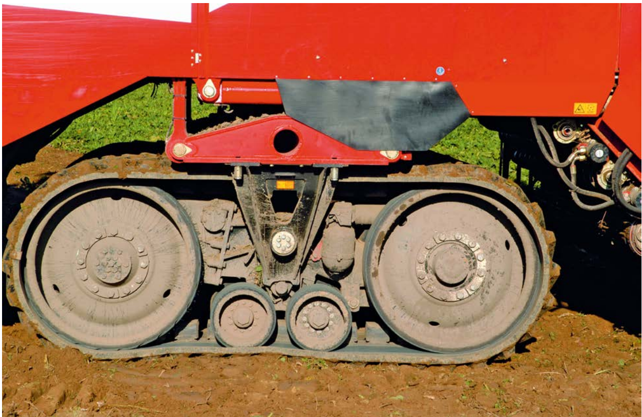
Abb. 1.1: Raupenfahrgestänge eines Zuckerrübenroders zur Verringerung des Bodendrucks (Foto: P. Meyer/BLE)
