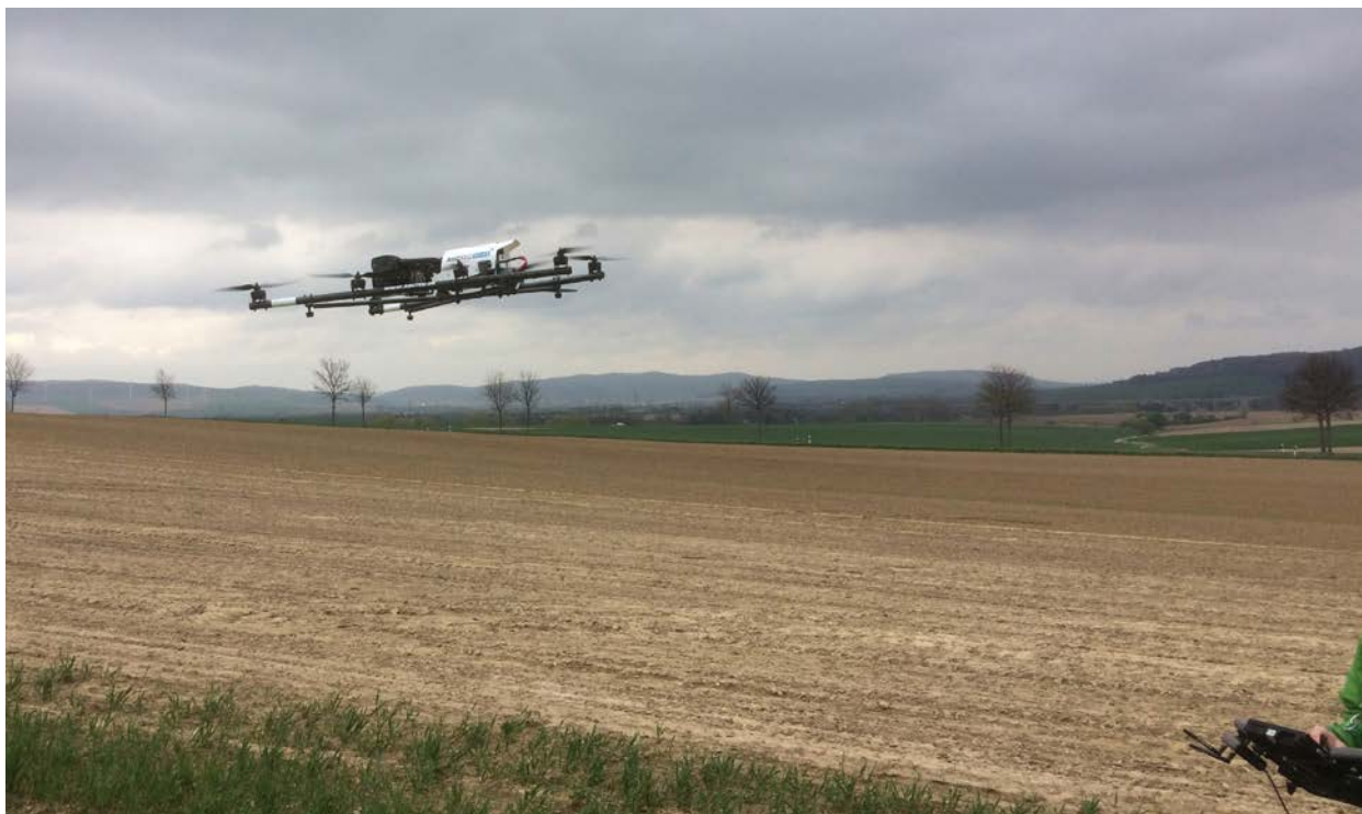
Abb. 4.38a: Drohneneinsatz zur Erosionsmessung (Foto: J. Brunotte)
