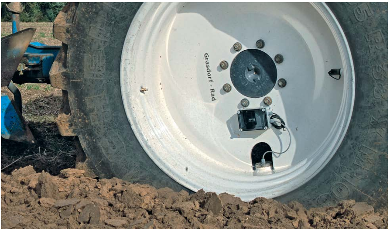
Abb. 3.22: Ultraschallsensor in der Felge (Foto: Ortmeier, TI)
