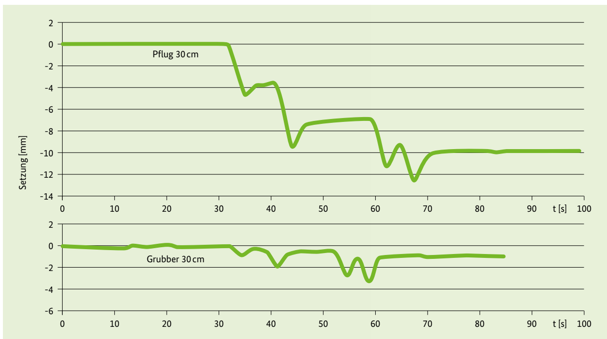
Abb. 3.29: Bodensetzung in 30 cm Tiefe bei Befahrung mit Traktor + Gülletankwagen nach unterschiedlicher Bodenbearbeitung (BRUNOTTE, 2013)
