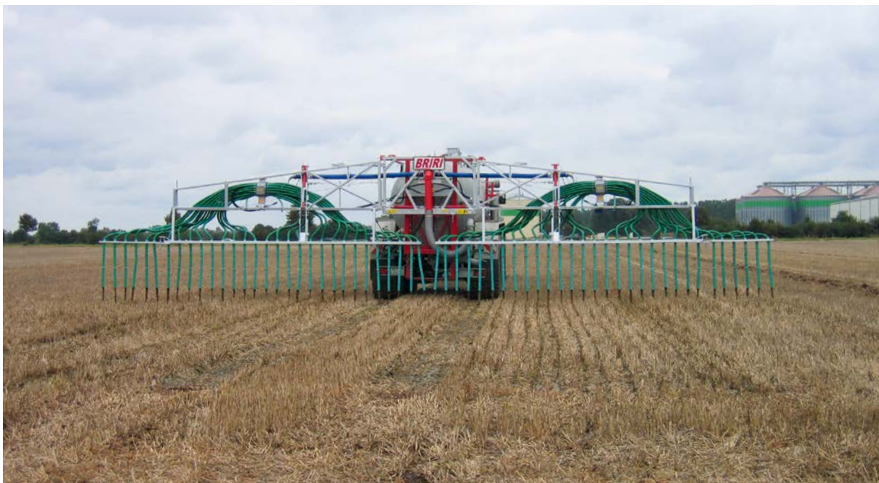
Abb. 2.7: Ausbringung von Gärresten mit Schleppschläuchen (Foto: TI Braunschweig)
