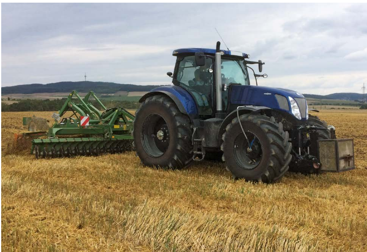
Abb. 3.13: Messtraktor mit Kurzscheibenegge (Foto: J. Brunotte)
