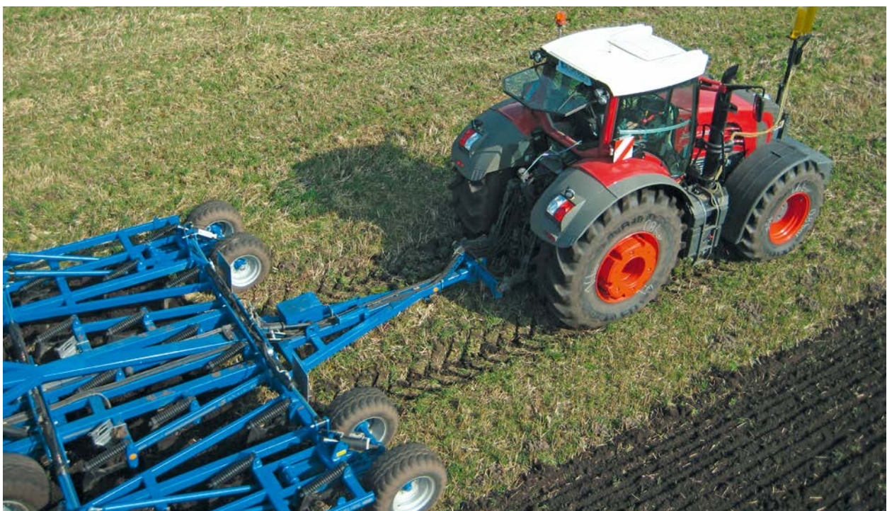
Abb.: 3.48: Traktor mit Kraftstoffmessung bei Zugarbeiten mit verschiedenen Reifeninnendrücken (Foto: L. Volk)
