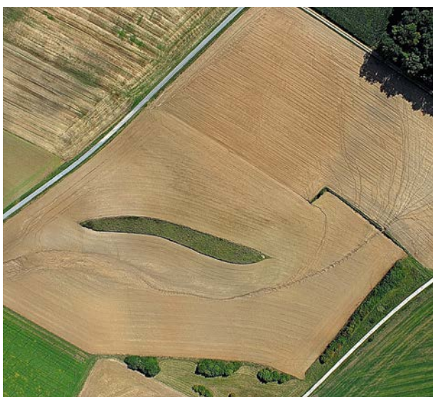
Abb. 4.64: Abflussbremsende Wirkung von Grünstreifen bzw. Ranken – i. d. R. begrenzt auf Abfluss in kleineren Abflussrinnen (Foto: W. Bauer, Agroluftbild)
