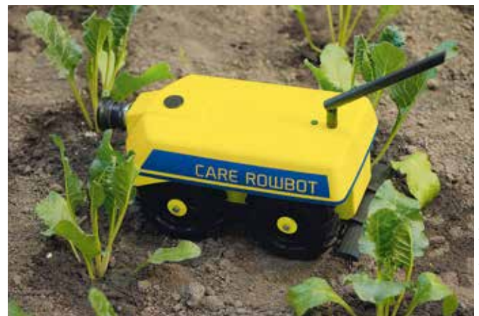
Miniroboter können gezielt einzelne Pflanzen im Feld versorgen.
