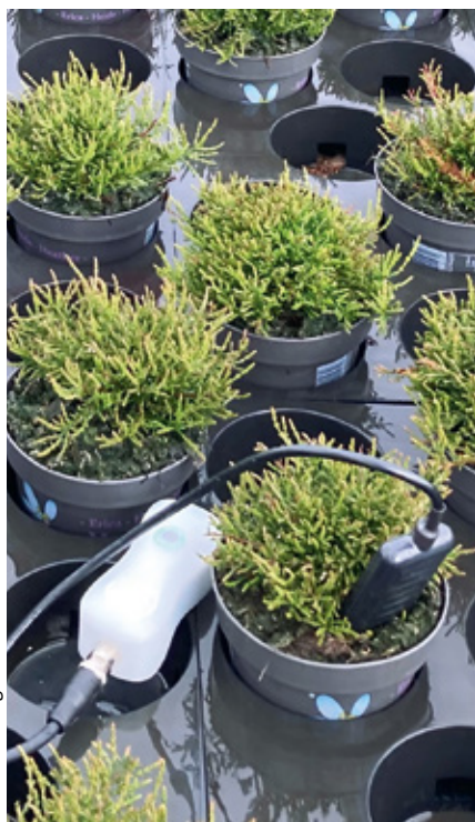
Sensor zur Messung der Bodenfeuchtigkeit im Topf auf einer Stellfläche mit Eriken
