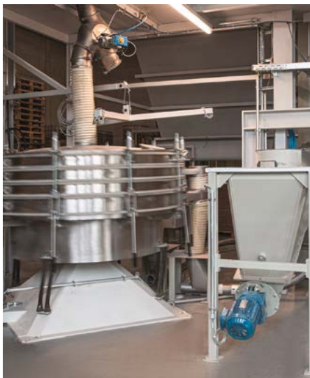
Bild 22: Pulvermühle zur Vermahlung der Erbsen/ Ackerbohnen zu feinen Mehlen. © Kramerbräu.
