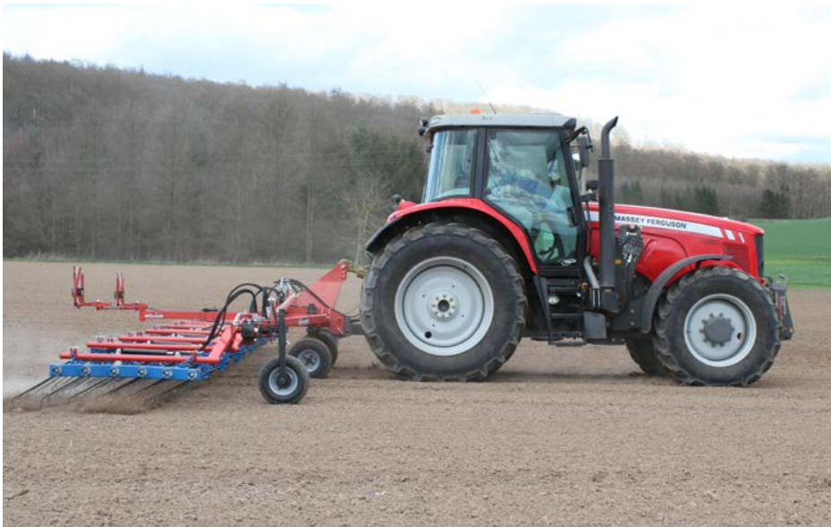
Bild 10: Blindstriegeln – hier Erbsen – ist eine frühzeitige und effektive Maßnahme zur Eindämmung von Unkräutern und Ungräsern; Foto: Michael Schlag
