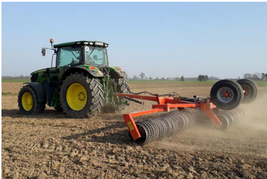
Bild 9: Anwalzen nach der Saat fördert den Bodenschluss und damit das Auflaufen der Körnerleguminosen; Foto: Katrin Stevens
