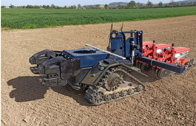
Abbildung 1: Roboter mit Säaggregaten zur autonomen, georeferenzierten Aussaat von Zuckerrüben. © JKI/M. Tomforde
