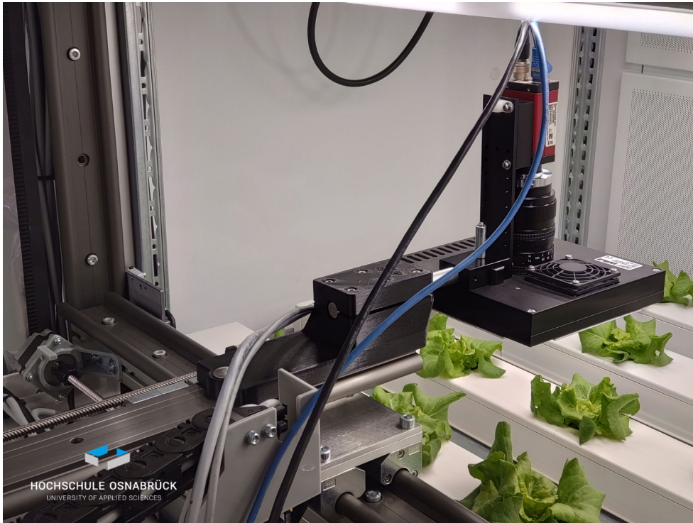
Abbildung 3: Laborteststand in einer vertikalen Farm zur automatischen Erfassung der Pflanzenparameter im Projekt LightSaverAI. © Hochschule Osnabrück
