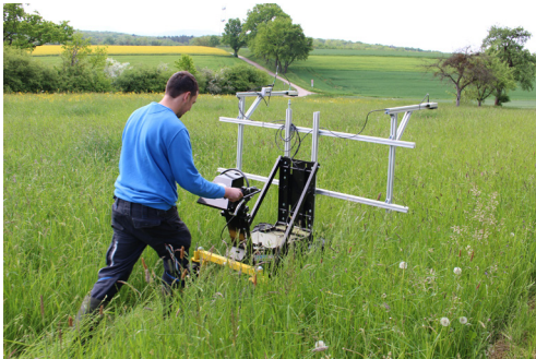
Abbildung 2: Handgeführtes, elektrisch angetriebenes Trägerfahrzeug bei der Aufnahmefahrt über eine befallene Wiese. Das angebaute Rahmengestell trägt zwei vorgelagerte Kameras, die den Grünlandbestand von oben abfilmen. Auf diese Weise erzeugte Videoaufnahmen werden im Nachgang aufbereitet und dienen zum Anlernen der Pflanzenerkennung mittels künstlicher Intelligenz. © HfWU/Haußmann
