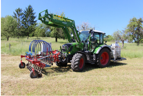
Abbildung 1: In der Front des Traktors angebautes Wasserstrahlgerät mit 2,50 m Arbeitsbreite, aufgeteilt in 10 Einzelsektionen. Der Wasservorrat befindet sich im Heckanbau. © HfWU/Haußmann
