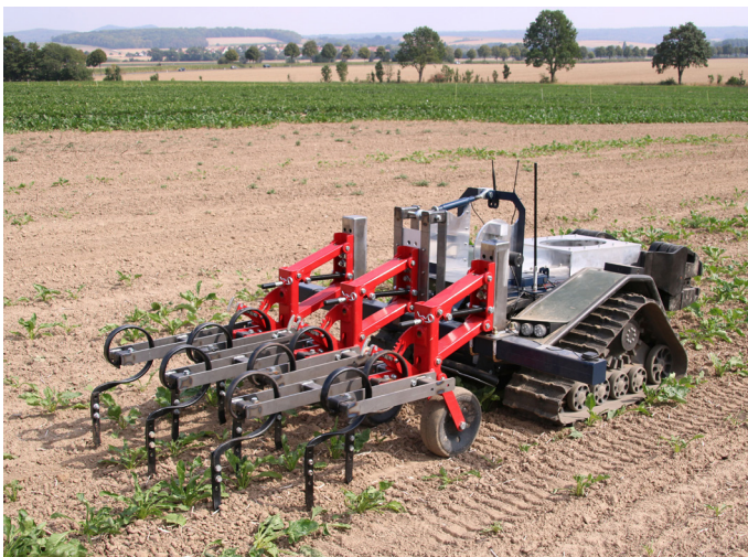
Abbildung 2: Roboter ausgerüstet mit Hackgerät. © JKI/M. Tomforde
