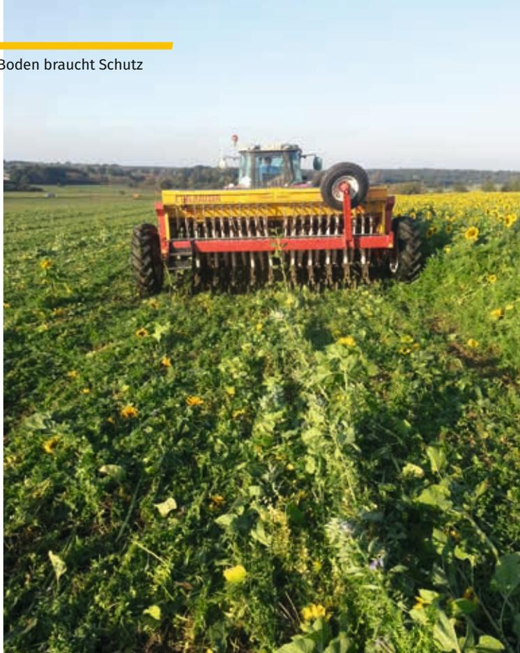
Direktsaat nach einer Zwischenfruchtmischung auf dem Betrieb Fromme: Dabei wird das Saatgut ohne vorherige Bodenbearbeitung ausgebracht.
