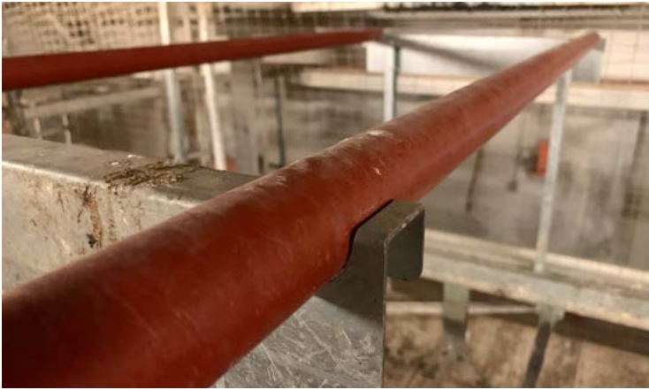
Mit Kunststoff ummantelte Sitzstange.
