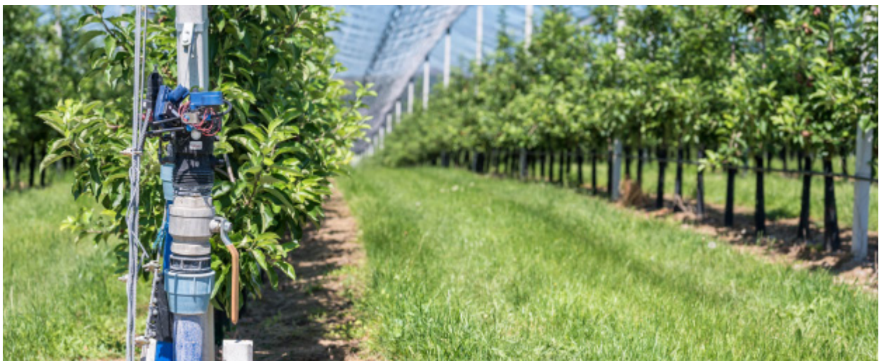
Bewässerungsanlage mit elektronischer Steuerung
