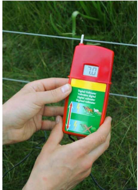
Digital-Voltmeter zur Messung der Hütесpannung.
