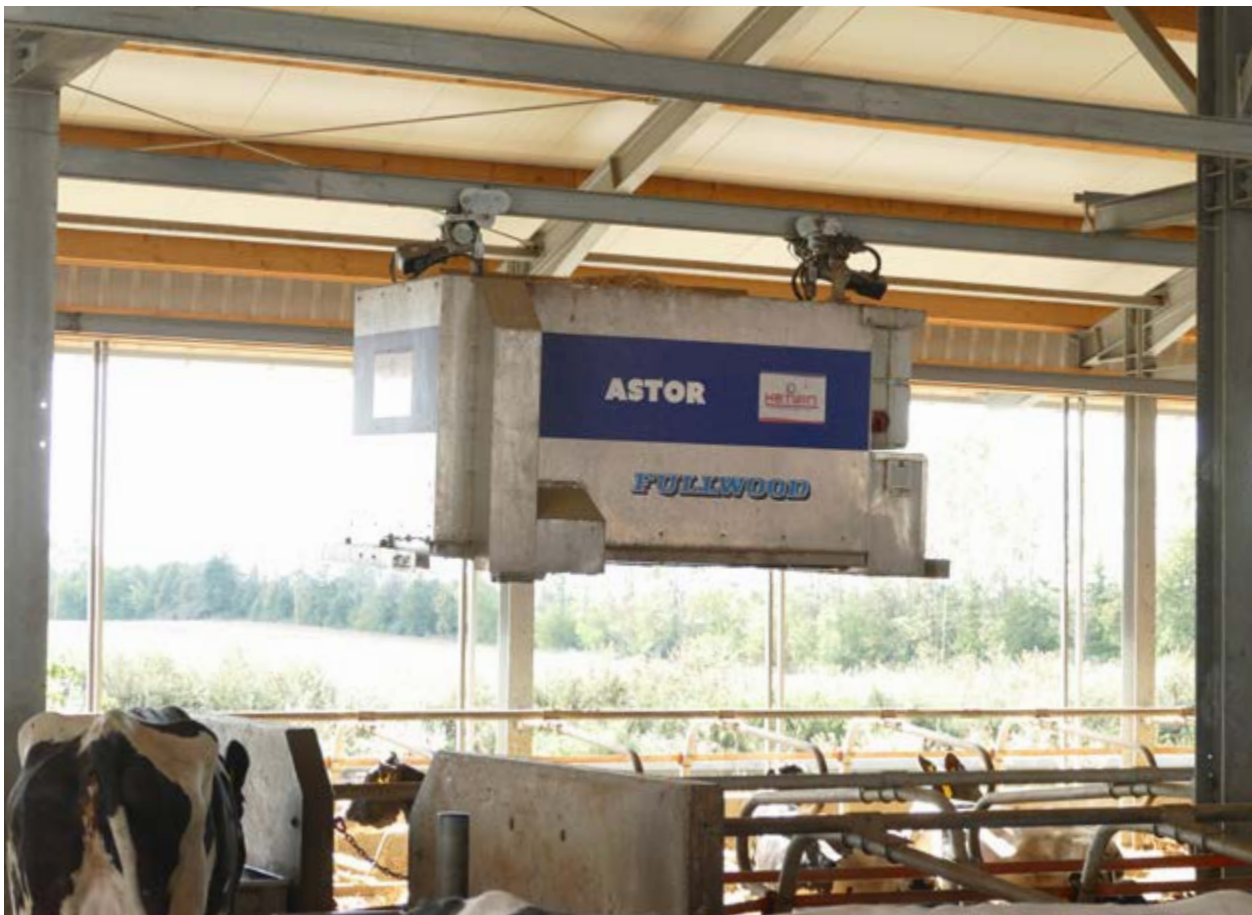
Abbildung 28: Schienengebundenes System zum Einstreuen.
