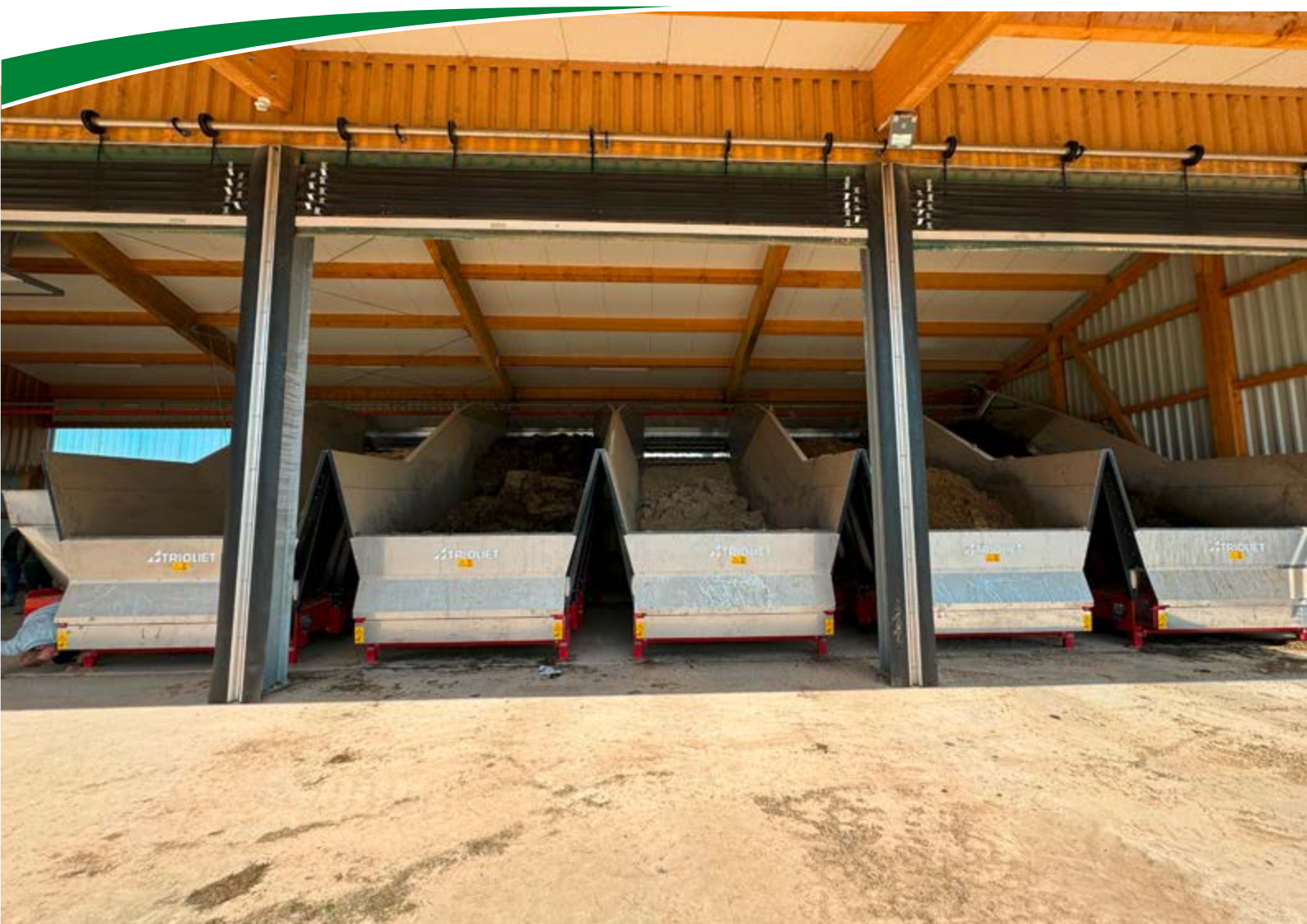
Abbildung 27: Befüllung des automatischen Fütterungssystems mittels Bunkern.
