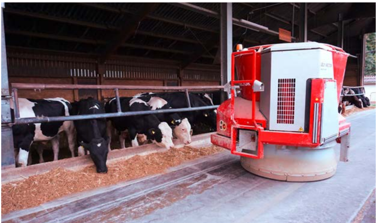
Abbildung 32: Automatische Fütterung im Mastrinderstall mit Spaltenboden.
