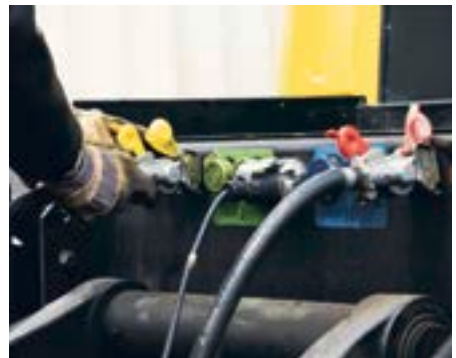
Zweileitungs-Druckluftbremsen sind an lof Zügen mittlerweile Standard.
