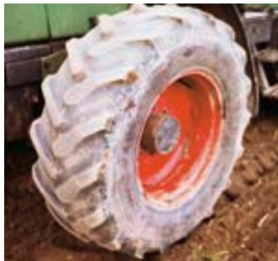
Abgefahrne Stollen von AS-Reifen vermindern die Traktion auf dem Acker. Häufig schnelles Fahren auf der Straße und nicht optimaler Reifennennendruck fördern den Abrieb.
