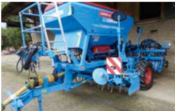
Bei angehängten Arbeitsgeräten muss ab 3 t Achslast eine Bremse vorhanden sein.
