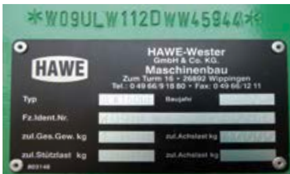
Die FIN ist im Fahrzeugrahmen eingeschlagen und auf dem Fabrikschild angegeben.
