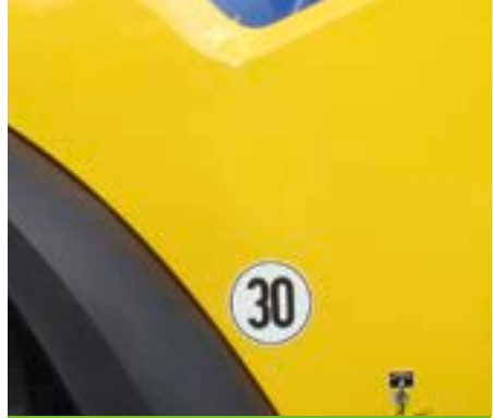
SfA erhalten jeweils seitlich und heckseitig ein Geschwindigkeitsschild (hier 30) mit der in den Fahrzeugpapieren eingetragenen Höchstgeschwindigkeit.
