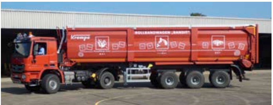
Sieht aus wie eine Sattelzugmaschine, ist aber ein Ackerschlepper mit Sattelanhängen.
