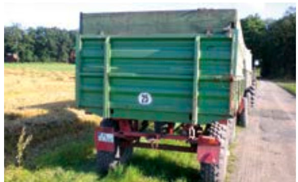
Bei zulassungsfreien lof Anhängern ist auf Vollständigkeit zu achten: 25 km/h-Schild, Wiederholungskennzeichen, Beleuchtung inklusive dreieckige rote Rückstrahler.
