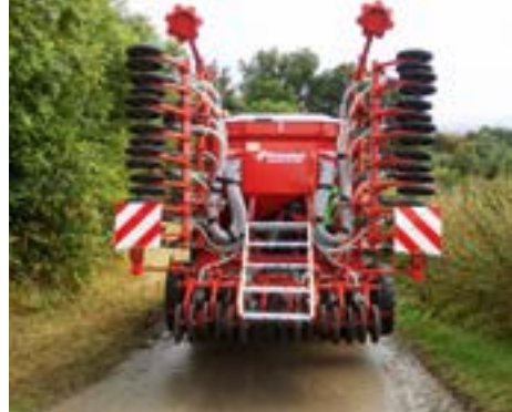
Beleuchtungseinrichtungen an Anbaugeräten. Die Warntafeln sind für die Kenntlichmachung und Absicherung verkehrgefährdender Teile erforderlich.
