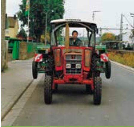
Auch zur Kenntlichmachung nach vorne sind zusätzliche Begrenzungsleuchten vorgeschrieben.
