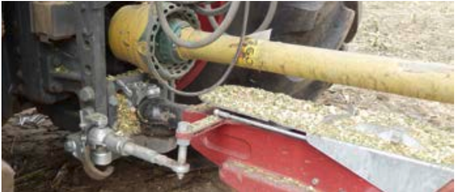
Durch das Lenkgestänge werden die Achsen bei schweren Tandem- und Tridemanhängern zwangsgelenkt.
