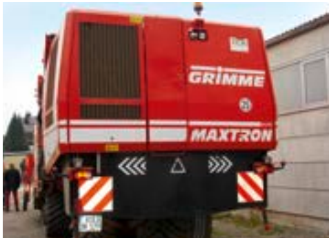
SfA – Rübenroder – front- und heckseitige Beleuchtung und Kennlichmachung. Heckseitige Markierung – schwenkt aus. Sicht nach hinten wird durch ein Kamerasystem unterstützt.
