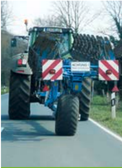
Durch den aufgesattelten Pflug wird die Lenkfähigkeit des Schleppers verbessert.
