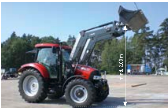
Ohne Kenntlichmachung und Absicherung muss der Mindestabstand zwischen Fahrbahn und Unterkante Frontladerschwinge bzw. Arbeitswerkzeug mindestens 2 m betragen.
