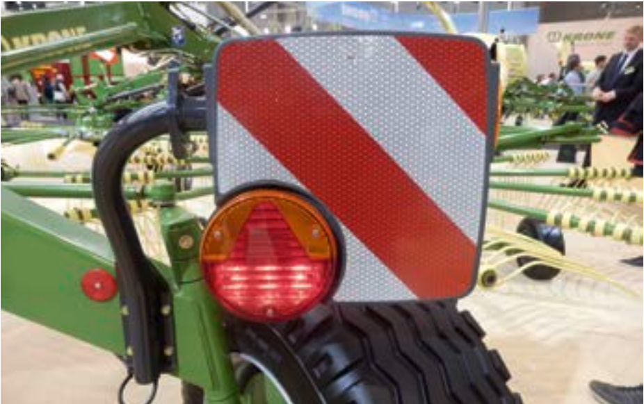
Nach der Verordnung (EU) 167/2013 können Signaltafeln auch mit der Beleuchtung kombiniert werden, wenn bestimmte Rahmenbedingungen eingehalten werden; hier im Bild Warntafel mit rechtsseitiger Ausrichtung.
