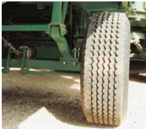
Die Reifen müssen eine Mindestprofiltiefe von 1,6 mm aufweisen.
