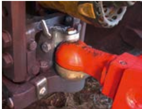
Die Kugelkopfkupplung kann relativ hohe Stützlasten aufnehmen. Eine regelmäßige Überprüfung des Verschleißzustands ist zu empfehlen.
