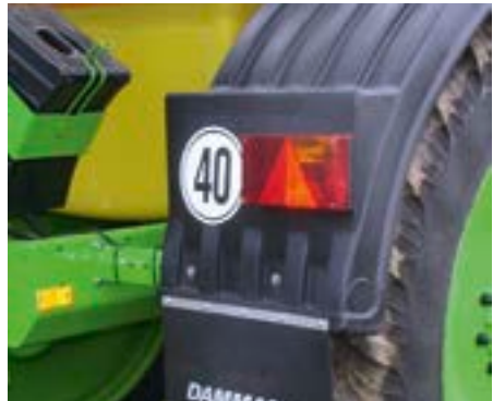
Häufig wird die zulässige Höchstgeschwindigkeit von angehängten lof Arbeitsgeräten heckseitig angebracht. Der Hersteller gibt die Höchstgeschwindigkeit vor.
