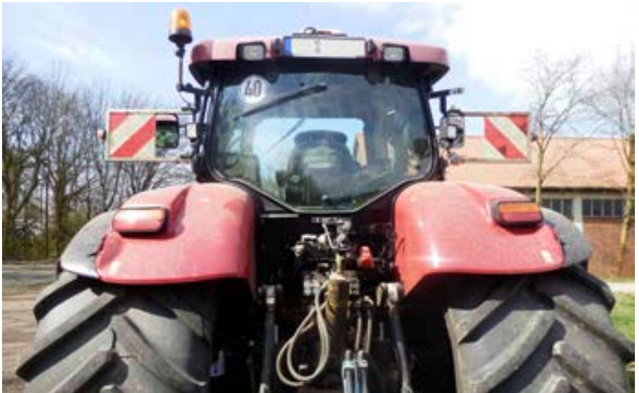
Schlepper mit Breitreifen dürfen nach der 35. AusnahmeVO und nach der VO (EU) 167/2013 bis zu 3,00 m breit sein.
