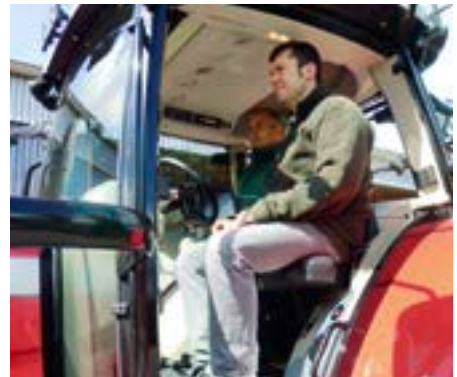
Auf dem Ackerschlepper müssen mitfahrende Personen auf geeigneten Mitfahrerplätzen sitzen.
