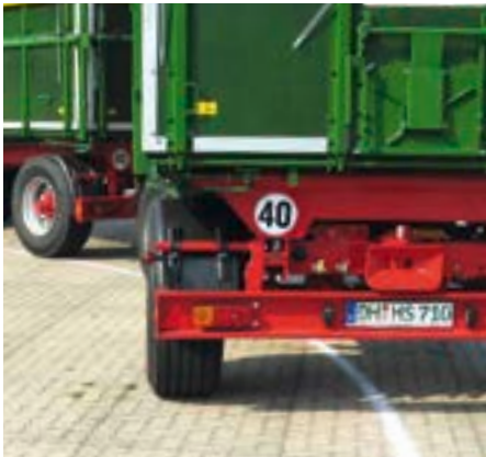
Die bauartbedingte Höchstgeschwindigkeit wird am Anhänger durch ein Schild dargestellt.
