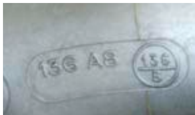
Die Geschwindigkeit und Reifentragfähigkeit sind auf dem Reifen durch Zahlen und Buchstaben dargestellt. A8 (40 km/h) und B (50 km/h); 136 (2.240 kg Tragfähigkeit). Entsprechende Tabellen stellen die Reifenhersteller zur Verfügung oder sind im Internet zu finden.
