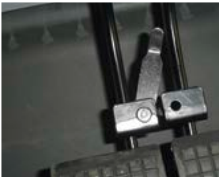
Die beiden Bremspedale dürfen nur auf dem Acker entriegelt sein.
