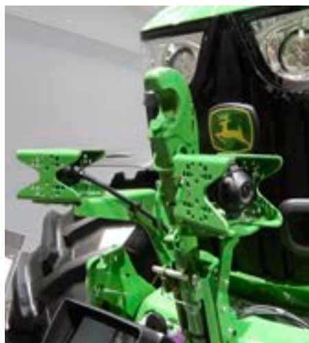
Zur Ausgleichung der Sichtfeldeinschränkungen zertifiziertes Vorbau-Kamera-Monitor-System (VKMS).
