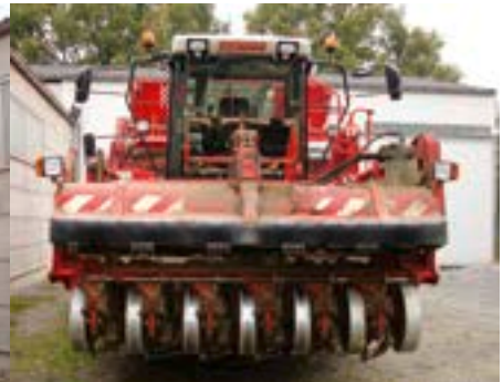
SfA – Rübenroder – front- und heckseitige Beleuchtung und Kennlichmachung. Heckseitige Markierung – schwenkt aus. Sicht nach hinten wird durch ein Kamerasystem unterstützt.
