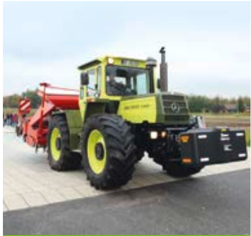
Beim Anbau von schweren Heckanbaugeräten kann durch ein Frontgewicht die sichere Lenkbarkeit des Traktors erreicht werden. Die Kenntlichmachung des Frontgewichts ist hier gut gelungen.
