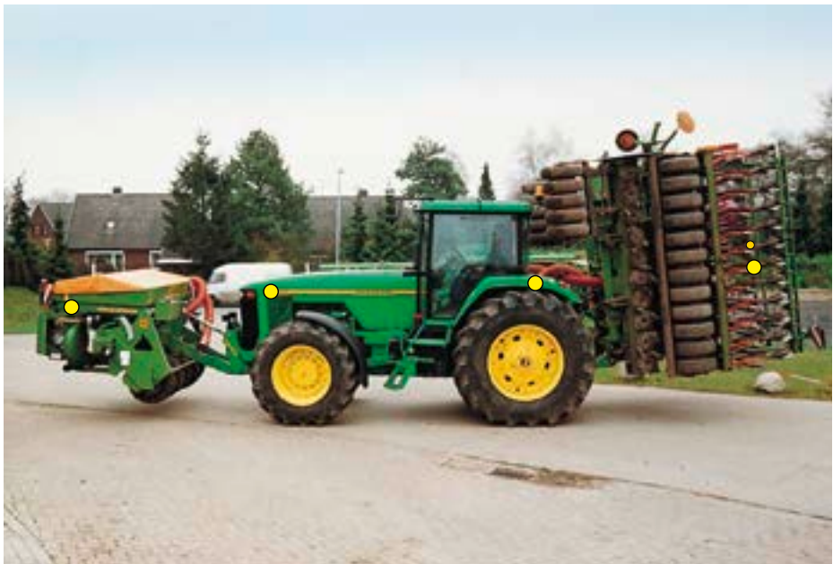
Seitliche Kennlichmachung mit Anbaugeräten bei mehr als 6 m Länge.
