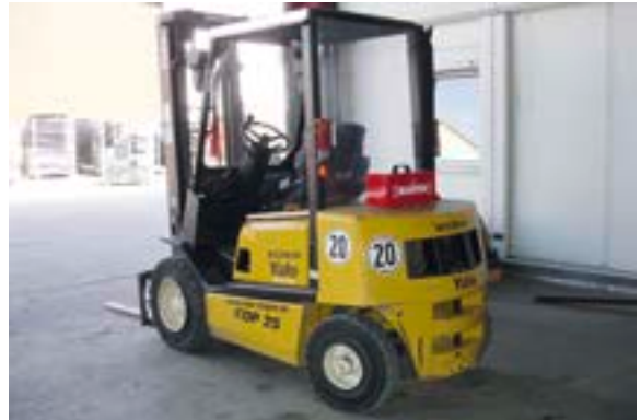
Der Gabelstapler kann zulassungsrechtlich als SO Kfz mit SN 18 8900 eingestuft werden. Die Vorgaben sind gleich der sFA.
