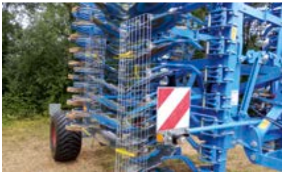
Die verkehrgefährdenden Teile sind an der Kurzscheibenegge mit Warntafeln kenntlich gemacht und mit Gittern abgedeckt worden.
