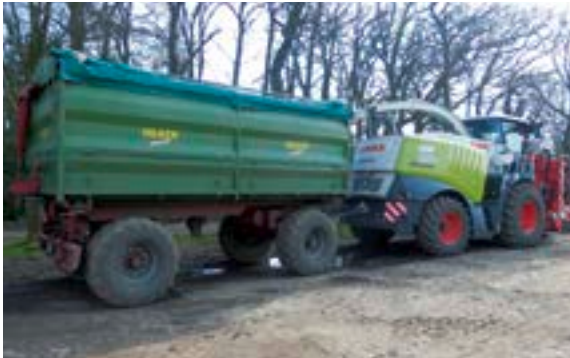
Hinter einer sfA darf ein Anhänger mitgenommen werden (Eintragung der Anhängelast und Anhängekupplung erforderlich).
