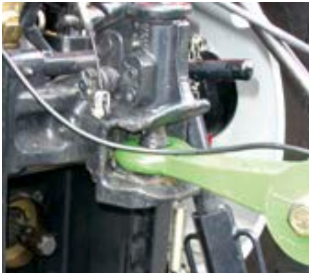
Die Stützlast bei der Bolzenkupplung beträgt in der Regel 2,00 t.
